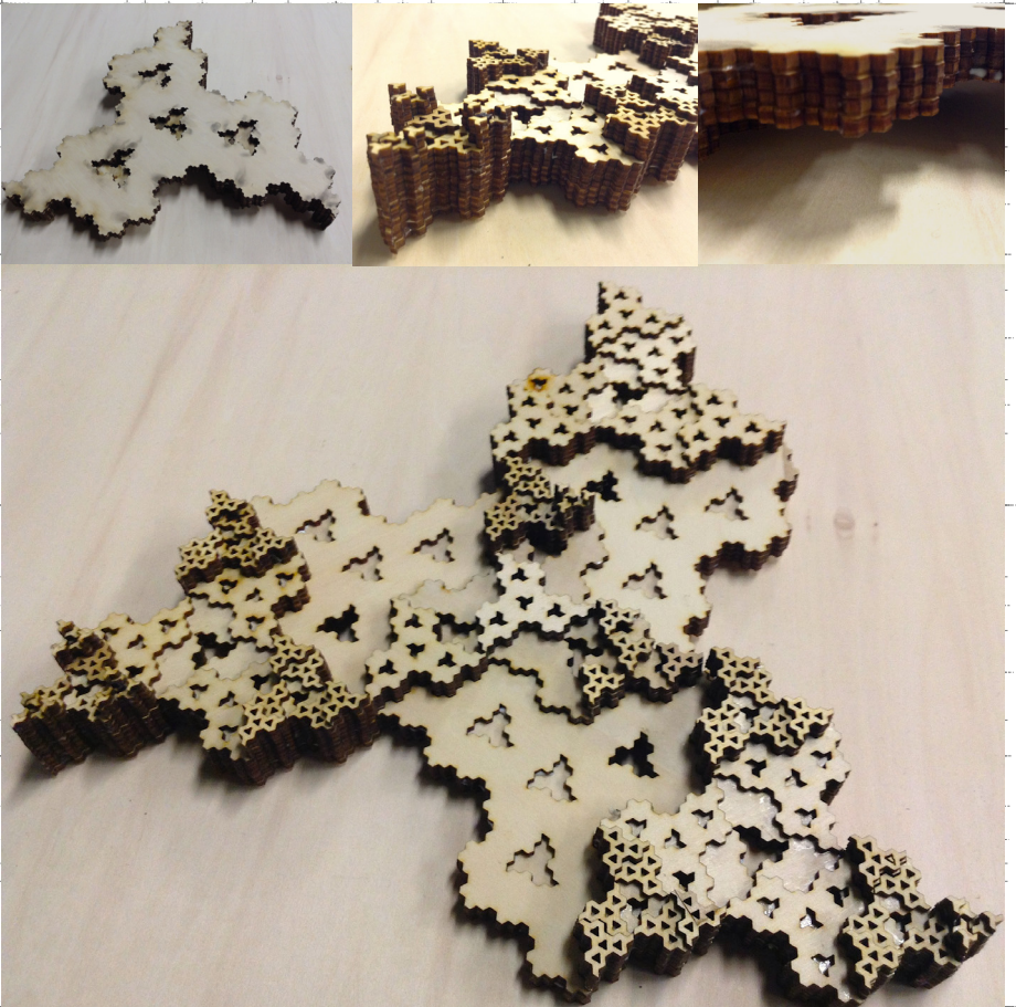
全体の形と積層の様子。2-3枚ごとにステップを小さくして積む。 積み上がるほど小さく複雑な形状になる。
